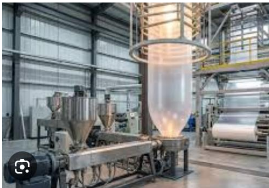
Рис.2 Фотография экструдера с раздувом «рукава» пленки.
