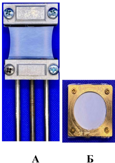
Рис. 20 (А) Фото зажима для растяжения полимерных образцов и (Б) рамка, позволяющая создать изометрические условия для исследования структуры, сформированной в процессе растяжения.
